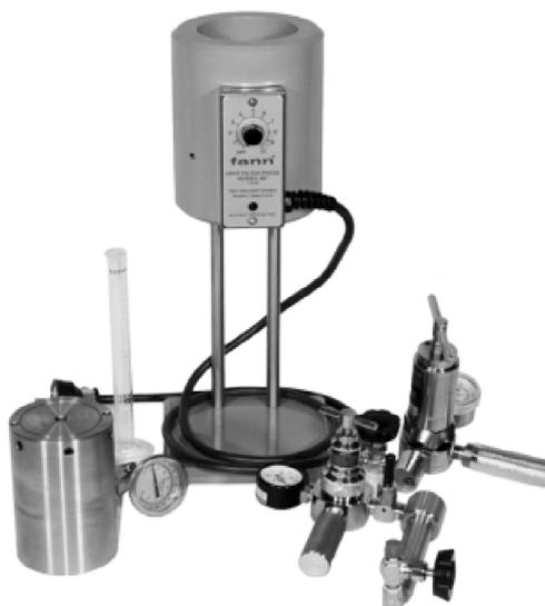
Figura 58 - Equipamento de filtração prensa em bancada utilizado no Laboratório de Tecnologia Mineral e Ambiental (LTM) da UFRGS para otimização de parâmetros de filtração de rejeitos. Fonte: acervo LTM.
